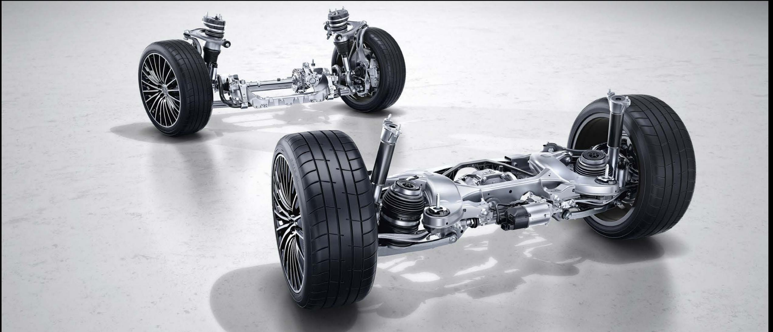
엔지니어링 패키지는 서스펜션 댐핑 조절이 가능한 DYNAMIC BODY CONTROL 서스펜션과 리어 액슬 스티어링 시스템으로 뛰어난 승차감과 역동적인 드라이빙 경험을 선사합니다. 특히 최대 4.5° 조향이 가능한 리어 액슬 스티어링을 통해 안정적이고 민첩한 주행이 가능합니다. 리어 액슬 스티어링은 회전 반경을 감소시켜 민첩한 핸들링이 가능하게 합니다. 또한, 프론트 액슬과 리어 액슬이 상호 작용하여 주행 시 최소한의 조향으로도 구동이 가능하도록 설계되었습니다. 안정적인 핸들링과 전반적인 안전성을 향상시켜 주어, 빠른 차선 변경 또는 회피 기동 시에도 안전하게 주행할 수 있습니다.
