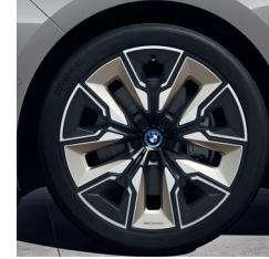
21인치 인디비주얼 에어로다이내믹 910 멀티스플러 티타늄 브론즈 3D 휠 및 타이어 사이즈 (앞) 9J x 21 255/40 R21 휠 및 타이어 사이즈 (뒤) 10.5J x 21 285/35 R21.
