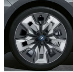
21인치 M 에어로다이내믹 910 멀티스플러 다크크로우 3D 휠 및 타이어 사이즈 (앞) 9J x 21 255/40 R21 휠 및 타이어 사이즈 (뒤) 10.5J x 21 285/35 R21.
