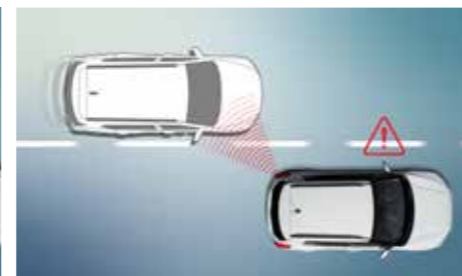
차선 변경 경고 LCW (Lane Change Warning) 후방에 70m 이내로 접근하는 추월 차량을 감지하고 1차(고속 추월 차량 존재 시), 2차(1차 경고 중 방향 지시등 조작 시)로 경고해 줍니다.
