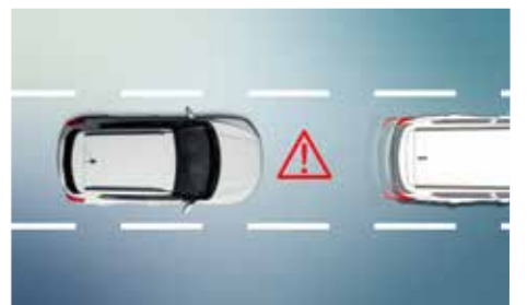
앞차 출발 알림 경고 FVSW (Front Vehicle Start Warning) 정차 중 앞차 출발을 운전자가 인지하지 못했을 때 경고 표시/경고음으로 전방 차량 출발을 알려줍니다.
