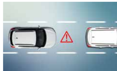
전방 추돌 경고 FCW (Forward Collision Warning) 주행 중 전방 추돌이 예상될 경우 운전자에게 경고해 줍니다.
