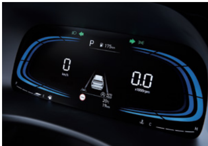
Full LED 헤드램프 (프로젝션 타입) / LED 주간주행등 클러스터 (4.2인치 컬러 LCD)
