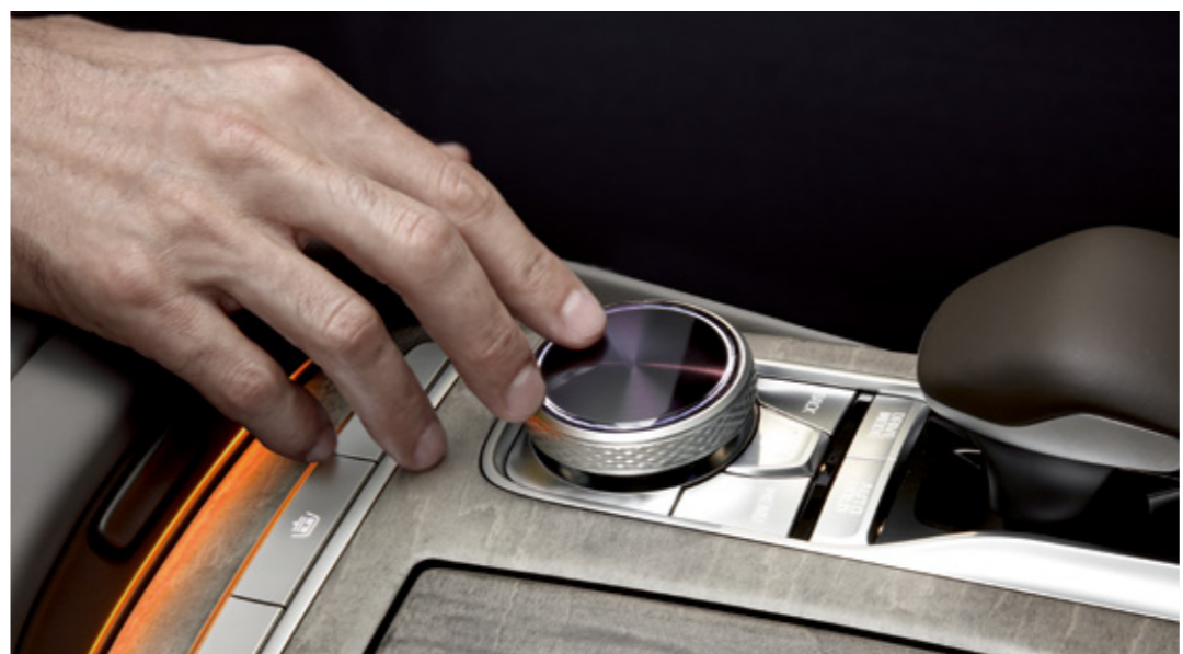
필기인식 통합 컨트롤러
