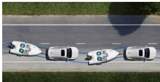
트레일러 스웨이 컨트롤 트레일러 견인 주행 중 트레일러가 주행 환경에 의해 좌우 흔들림 발생 시 차량의 조향에 영향을 주는 흔들림 현상을 컨트롤하여 보다 안전한 주행이 가능합니다.
