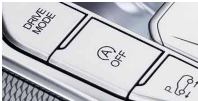
ISG 시스템(공회전 제한 장치) 신호 대기 등의 이유로 정차 시, 자동으로 엔진을 정지시켜 공회전을 방지하고 연비 향상을 도와줍니다. 브레이크를 떼거나 액셀레이터를 밟으면 자동으로 시동이 걸립니다.
