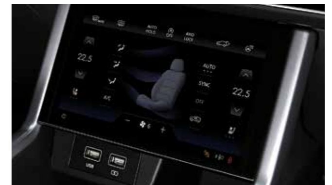
주요 통합 기능 : 공조장치 / 시트 통풍 열선 / 헤드램프 레벨링 / ISG 온 오프 / 전방 감지센서 / 통합 주행모드 / 오토홀드 / 스티어링 휠 열선 / 스마트 테일게이트 / 윈도우 열선 / 디프리스트 설정
