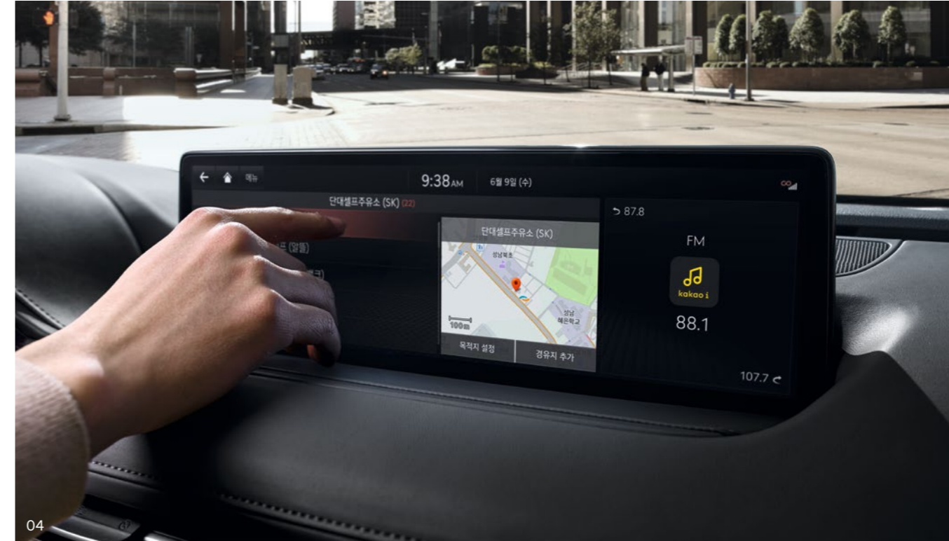
04. 14.5인치 인포테인먼트 시스템 _ 분할 스크린 기능의 와이드 디스플레이로 미디어, 날씨, 내비게이션 등을 우측에 별도로 표시하며, 터치 방식의 제어는 물론, 제네시스 통합 컨트롤러를 통한 손 글씨로도 실행이 가능합니다. 자연어 기반의 음성 인식 기능은 운전자가 “시원하게 해줘”라고 말하면 에어컨을 작동시키거나 창문을 열어주며, 카카오톡 송수신 서비스는 운전자의 음성 명령대로 카카오톡 메시지를 작성하여 수신자에게 전송합니다. 블루투스 및 유선을 통한 스마트폰 연결 없이도 뮤직 스트리밍(지니/멜론) 서비스를 즐기고, 제네시스 카페이로 편리하게 결제할 수 있으며, 최신 지도 및 각종 소프트웨어는 자동으로 무선 업데이트됩니다. ※ 뮤직 스트리밍 서비스는 별도 데이터 요금제 가입 후 이용하실 수 있습니다.
