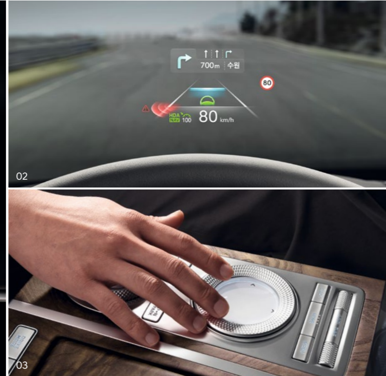
02. 헤드업 디스플레이 _ 주행속도, 내비게이션 정보 등은 물론, 운전자 보조 시스템의 주요 정보들과 갈림길 정보 등을 표시합니다. 12인치 와이드의 고화질 디스플레이로 주-야간 모두 시인성이 뛰어납니다. 03. 제네시스 통합 컨트롤러 _ 센터 콘솔에 위치한 통합 컨트롤러는 복잡하게 버튼을 누르거나 화면을 여러 번 터치할 필요 없이 다양한 인포테인먼트 시스템을 손쉽게 조작할 수 있도록 도와줍니다. 또한, 필기 인식 기능을 적용하여 키보드 입력 대신 손 글씨로 목적지 및 전화 번호부 검색 등을 간편하게 실행할 수 있습니다.
