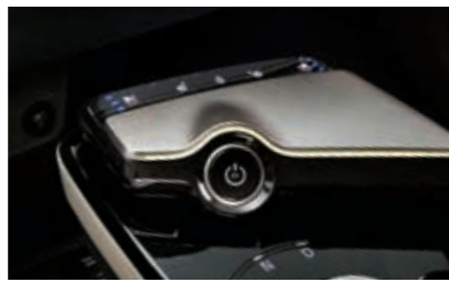
센터 콘솔 터치 스위치 시트 열선이나 통풍, 스티어링 휠 열선을 콘솔에서 터치식으로 조작할 수 있습니다.
