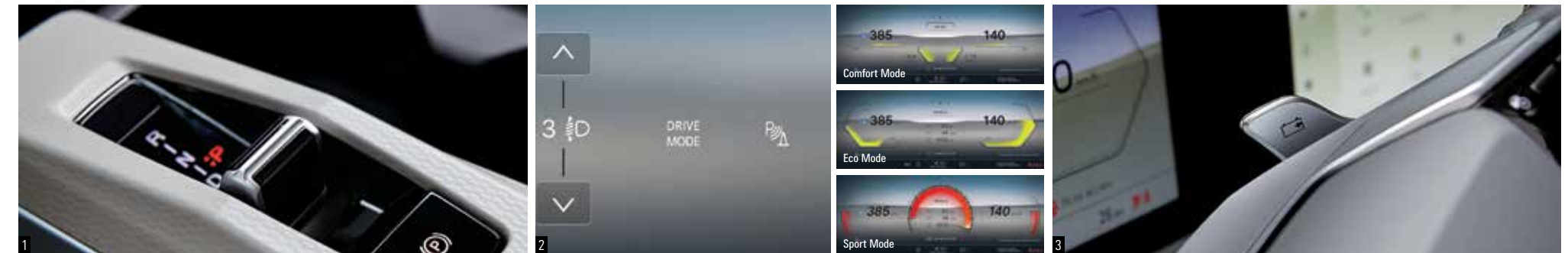
1. 토크스위치 타입 전자식 변속시스템 2. 드라이브 모드 시스템 (Comfort Mode/Eco Mode/Sport Mode) 3. 회생제동 컨트롤 패들 스위프트
