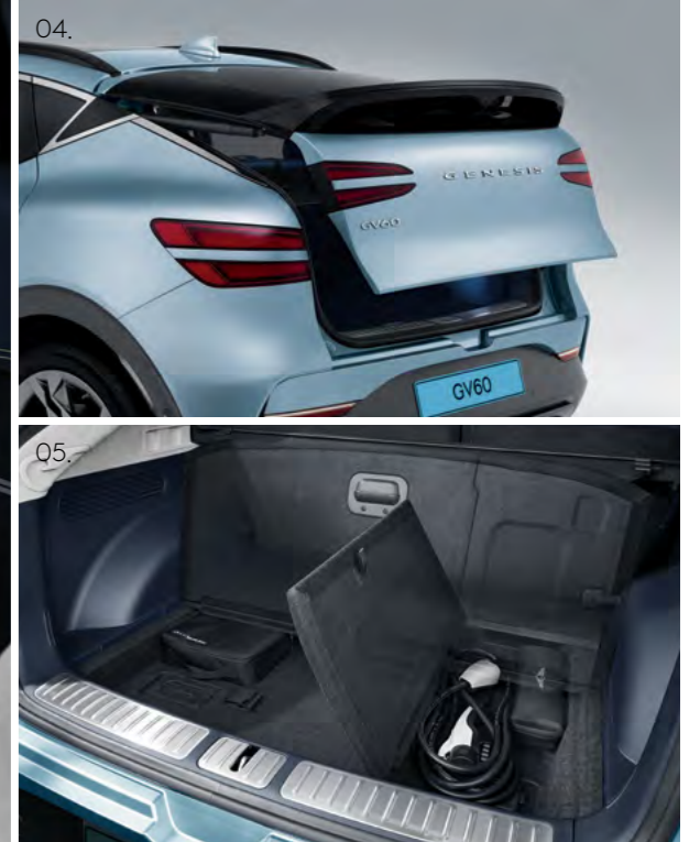
05. 멀티폴딩 러기지 보드 _ 적재물에 따라 다양한 형태로 폴딩하며 러기지 공간을 효율적으로 사용하여 러기지 보드 하단 내 수납성과 실용성을 개선하였습니다.
