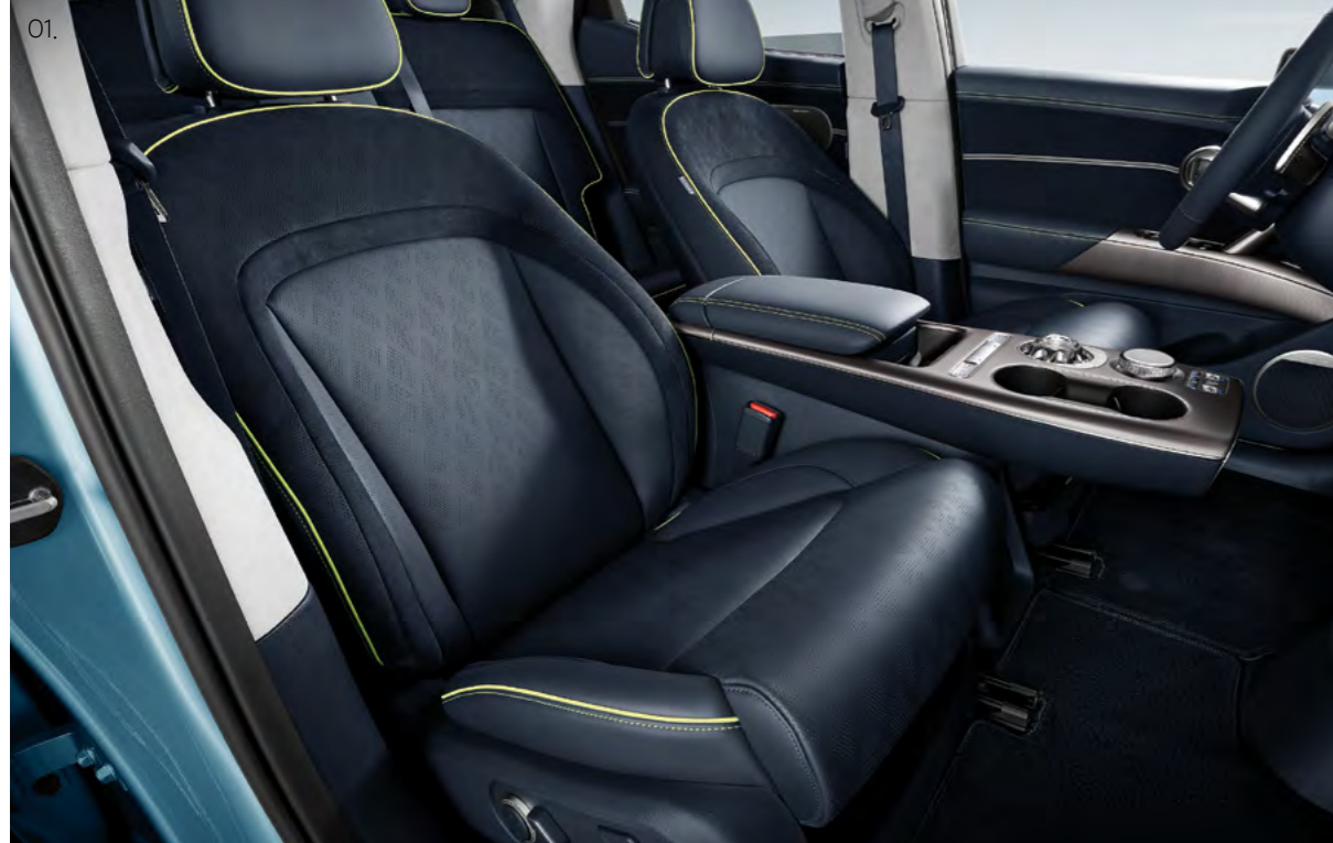
01. 앞좌석 릴렉션 콕포트 시트 _ 운전석과 동승석에 릴렉션 콕포트 시트를 적용해 충전 시 또는 휴식 필요 시 체압 분포가 최적화되는 무중력 자세를 구현하여 피로감을 낮추고 안락함을 높이는 편안한 휴식을 선사합니다.
