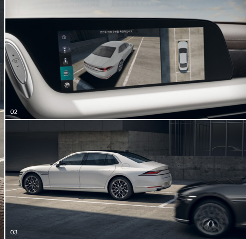
02. 서라운드 뷰 모니터 _ 안전한 주차를 위해 차량 주변 상황을 영상으로 보여줍니다. 03. 안전 하차 보조 _ 정차 후 탑승자가 차에서 내리려고 도어를 열 때 후측방에서 접근하는 차량을 인식하면 경고를 해주며, 전자식 차일드 락을 잠금 상태로 유지해 도어가 열리지 않도록 도와줍니다. 또한 후측방 충돌 위험이 판단되면 도어 열림 버튼을 눌러도 도어가 열리는 것을 방지합니다.
