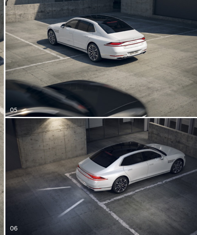
05. 06. 후방 교차 충돌방지 보조 _ 후진 중에 좌우측에서 다가오는 차량과 충돌 위험이 감지되면 경고를 보내고 위험도가 높아지면 자동으로 제동을 도와줍니다. 후진 가이드 램프 _ 차량 후진 시 프로젝션 타입의 가이드 조명을 후방 노면에 비춰 보행자와 주변 차량에 후진 의도를 더욱 선명하게 전달합니다.
