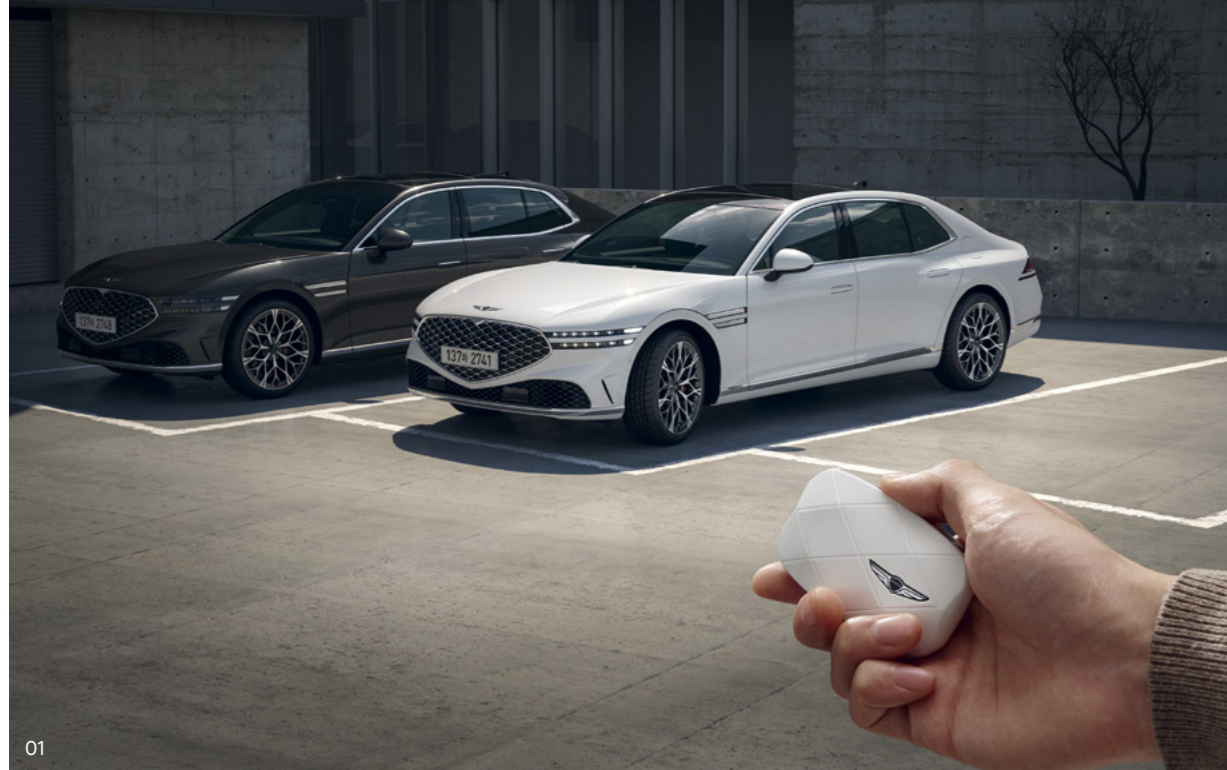
01. 원격 스마트 주차 보조(주차 구획선 인식 및 사선 주차 포함) _ 차량 외부에서 원격으로 주차 및 출차를 할 수 있도록 도와줍니다. 주차 구획선을 인식하여 직각 주차, 평행 주차, 사선 주차를 보조할 수 있습니다.
