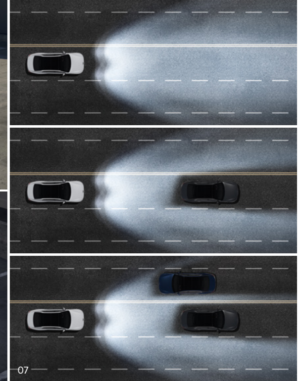
07. 지능형 헤드램프 _ 주변 상황을 인지한 상시 상황등 부분 소등으로 마주 오는 전방 차량 영역의 빛을 부분적으로 차단해 상대차 운전자의 눈부심을 막아주는 한편, 운전자의 전방 시야를 안전하게 확보합니다. 선행 차량 영역에도 동일하게 작동하며, 별도로 헤드램프를 조작할 필요가 없어 야간 운전이 수월해집니다.
