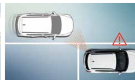
안전 하차 경고 SEW (Safety Exit Warning) 주차 후 하차할 때 후측방으로 차량이 접근할 경우 경고 표시/경고음을 탑승객에게 알려줍니다.
