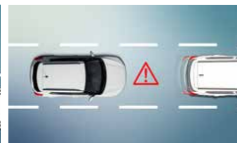
앞차 출발 알림 경고 FVSW (Front Vehicle Start Warning) 정차 중 앞차 출발을 운전자가 인지하지 못했을 때 경고 표시/경고음으로 전방 차량 출발을 알려줍니다.
