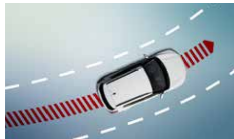
중앙 차선 유지 보조 CLKA (Centering Lane Keeping Assist) 주행 시 스스로 스티어링 휠(EPS)을 작동하고 차선을 중앙으로 유지하여 주행할 수 있게 하는 시스템입니다.
