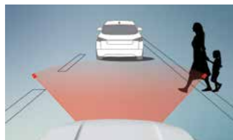
긴급 제동 보조 AEB (Autonomous Emergency Braking) 주행 중 전방 충돌이 예상될 경우 운전자에게 경고하고, 자동으로 제동 브레이크를 작동시켜 사고를 미연에 방지해 줍니다.
