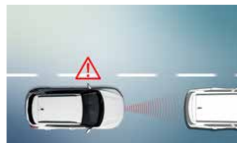
안전거리 경고 SDW (Safety Distance Warning) 주행 중 운전 차량 속도 대비 전방 차량과의 안전거리 미확보 시 운전자에게 경고해 주는 기능입니다. (안전거리 기준은 운전 차량 속도에 따라 유동적)
