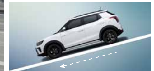
경사로 저속 주행장치 가변형 HDC (Hill Descent Control) 급경사 주행 시, 자동 저속 주행 장치가 작동되어 급가속 되지 않도록 속도를 조절해 줍니다.
