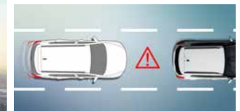
급제동 비상 경보장치 ESS (Emergency Stop Signal) 차량 급정거 시 비상등을 자동으로 점등시켜 뒷차에게 위험을 알려줍니다.
