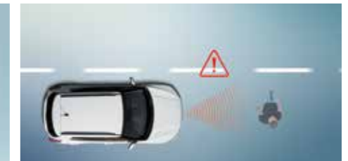
제동보조 장치 BAS (Brake Assist System) 급제동 시 브레이크의 압력을 증대시켜 제동거리를 줄이고 사고를 방지해 줍니다.
