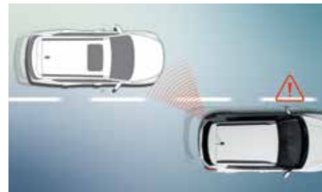
후측방 경고 BSW (Blind Spot-Detection Warning) 차로를 변경할 때 후측방에 위치한 상대 차량과의 충돌 위험이 있다고 판단되면 운전자에게 경고해 주고, 편제동 제어를 통해 원래의 차선으로 유지시켜주는 기능입니다.
